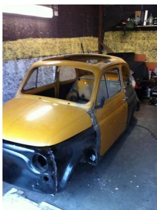
Nun ging es an das anpassen der Spaltmasse und restliche Kleinarbeiten am Unterboden, sowie versiegeln und vorbereiten für den Lackierer
